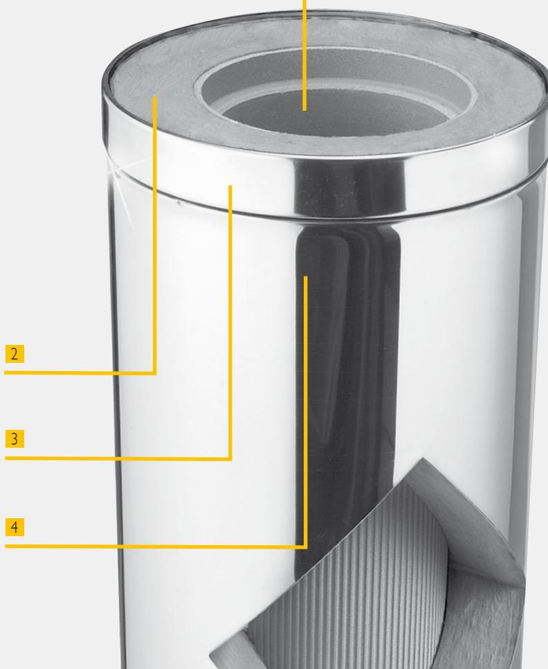
**2** Теплоизоляция состоит из высококачественного минерального волокна (толщиной 60мм), которое обладает исключительными изоляционными свойствами. Никаких мостиков холода, так как теплоизоляция охватывает трубу целиком.
