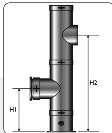
Высота подключения дверцы для осмотра и очистки и тройника для подключения потребителя (45°, 90°) при монтаже на настенных консолях.
