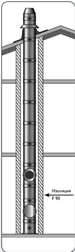
При размещении KERASTAR внутри здания обратите внимание на необходимость выполнения защиты всей конструкции изоляцией класса не ниже F90 вплоть до кровельных конструкций.
