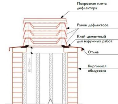
Варианты установки дефлектора 39/53 на типовые комбинации вентканалов
