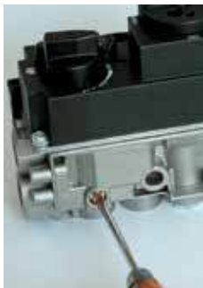
Rys. 13. Sposób regulacji minimalnej wysokości płomienia palnika głównego
