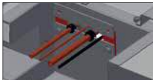
Рис.9. Способ проводки и герметизации проводов, трубки главной горелки и трубки контрольной горелки.
