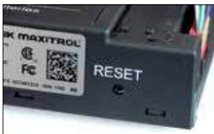
Рис. 16. Отверстие « RESET» - приемник
