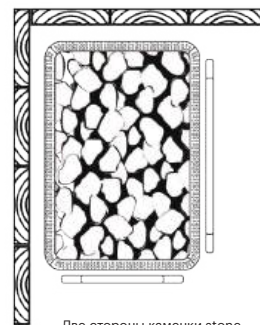
Две стороны каменки stone прилегают к стене
