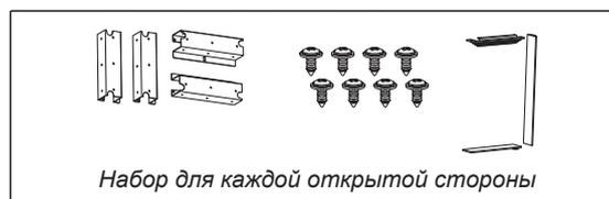
При панорамном варианте установки камина с тремя стёклами и угловом варианте установки камина с двумя стёклами установите детали боковой отделки на каждой из открытых боковых сторон.
