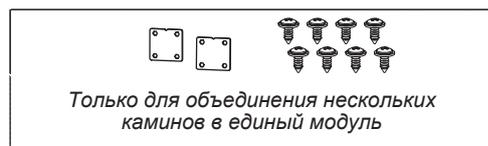
При необходимости объединения нескольких каминов в единый модуль установите дополнительные кронштейны между подсоединяемыми каминами.
