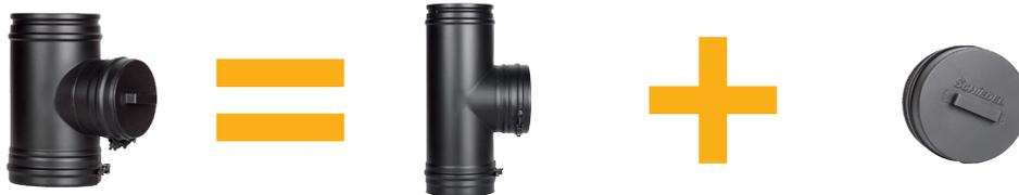
Тройник прочистки (6с) комплектуется по следующему принципу: к тройнику 90° (6а) добавляется заглушка тройника (3с). Для теплогенераторов, работающих под избыточным давлением (настенные газовые котлы), вместе с заглушкой для обеспечения требуемой газоплотности необходимо заложить силиконовую манжету (см. раздел аксессуары Prima)
