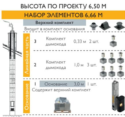
**Пример 1.** Дымоход ISOTOR. Дымоход для камина или банной печи. Общая высота дымоходной системы 6,5 м. Внутренний диаметр дымового канала 20 см. Без вентиляционного блока. Верхний комплект – по месту. Её комплектация будет выглядеть следующим образом:
