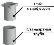
Линейные участки дымохода ISOTOR формируются из комплектов высотой 0,33 и 1,0 м. Комплекты составлены так, что как минимум каждая третья труба – труба с диффузорами.
